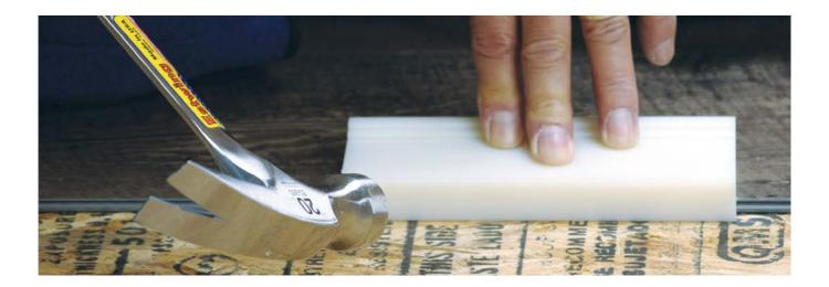
Mit einem Qualitäts-Schlagklotz wird die fachmännische Verlegung noch einfacher! Eine praktische und professionelle Hilfe bei der Verlegung von Fussböden mit Click-Profilen.
