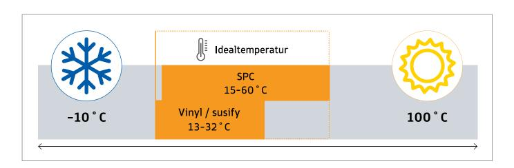
Die maximale Oberflächentemperatur von 60 °C bei SPC-Böden und von 32 °C bei Vinyl-/susify-Böden darf nicht überschritten werden. Außerdem muss ein sehr schneller Aufheizvorgang vermieden werden.
