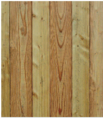
Abb. 1: Sichtschutzelement nach 1-3 Monaten Bewitterung (ohne Pflege). Die unbehandelte Holzoberfläche weist einen beginnenden Bewuchs durch Bläue- und Schimmelpilze auf.
