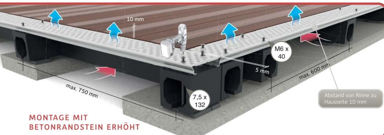
MONTAGE MIT BETONRANDSTEIN ERHÖHT
