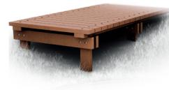
Die Konstruktionsbohle kann mit einem Achsmaß bis zu 120 cm und einem Überstand bis zu 20 cm als Stegdeck eingesetzt werden.\*
