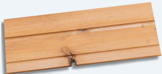
Mängel, die nach der Montage nicht sichtbar sind
