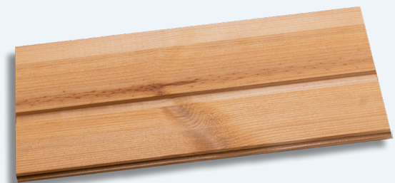
Moderate Risse im Bereich der Äste
