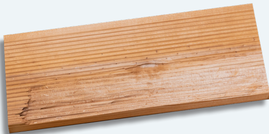
Bretter mit Schäden, die nicht weggeschnitten werden können
