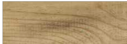
Stockflecken mit chlorhalt. Reiniger entfernen
