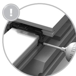
Klammern mit den mitgelieferten Schrauben am Konstruktionsbalken fixieren. Schrauben nicht festziehen.
