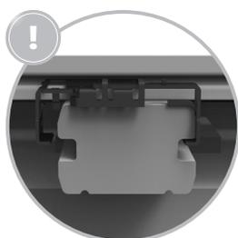
Rastklammer- Rand stirnseitig auf den Konstruktionsbalken schieben.
