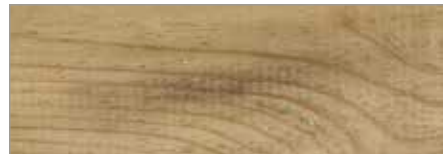
Stockflecken mit chlorhalt. Reiniger entfernen
