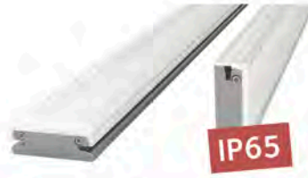
LED-LINEAR-LEUCHTEN H: 21 mm; W: 62 mm, L: 360 cm (27 W), 480 cm (36 W), 600 cm (45 W); 24 V DC IP65 Aluminium/Kunststoff, inkl. Zubehör für senkrechten o. waagerechten Einbau Hinweis: Leuchte 600 cm mit 2 Strom- anschlüssen, teilbar für 2 Wunschlängen
