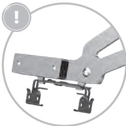
Setzen Sie die Klammer auf den Zammer und im Anschluss von oben auf den Konstruktionsbalken.
