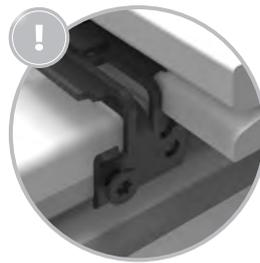
Nach jedem Meter die Klammern am Konstruktionsbalken fixieren.
