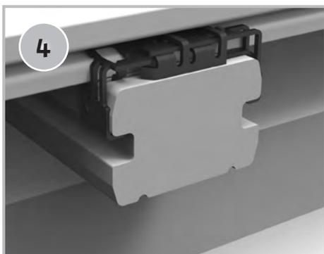
Wiederholen der Schritte 1 - 3 bis zur letzten Diele. Zum Befestigen der Rastklammer-Rand eine 10 mm vom Rand entfernte Nut (ca. 3 mm breit, 5 mm tief) in den Konstruktionsbalken sägen und die Rastklammer-Rand setzen.
