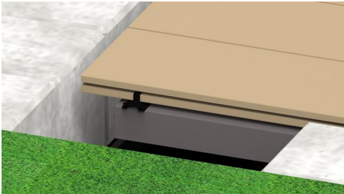
Bild 28. Wenn die letzte WPC-Diele mit dem Anfangs-/Endclip befestigt werden soll, muss die Unterkonstruktion ca. 10–13 mm über die letzte WPC-Deile vorstehen.
