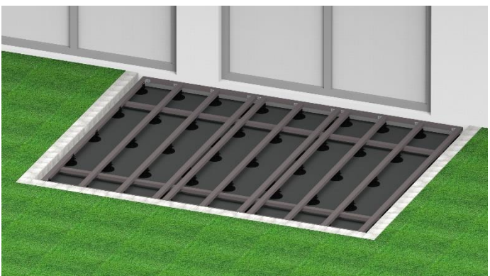
Bild 10. Mit mindestens 2 untergeschraubten Unterkonstruktionen kann eine einfache und stabile Aussteifung erzielt werden.
