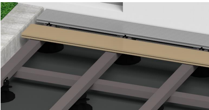
Bild 21. Wenn alle Anfangsclipse montiert worden sind, wird die erste WPC-Diele auf den Clip geschoben.
