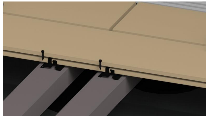
Bild 26. Auch die durchgehenden Dielen sollten mit 2 Clipsen befestigt werden.
