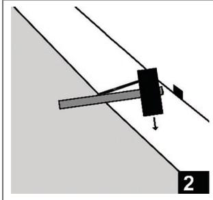
Danach klicken Sie die nächste Diele am Kopfende an, bis diese durch leichtes Klopfen mit einem Gummihammer in der Verbindung verriegelt und eben auf dem Boden aufliegt. Dies wiederholen Sie, bis Sie am Ende der ersten Reihe angekommen sind. Wichtig ist, dass die erste Reihe plan liegt. Wir empfehlen, diese zu beschweren.
