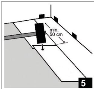
Die nächsten Dielen werden schräg in einem Winkel von ca. 20 Grad in der vorherigen Reihe längsseits eingeklickt. Das Kopfende wird durch leichtes Klopfen mit einem Gummihammer von oben verriegelt. Wiederholen Sie diesen Vorgang bis zum Raumende.
