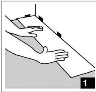
Legen Sie die erste Diele in die Ecke des Raumes, so dass die Nase der Klickverbindung zu Ihnen zeigt und die Rückseite der Diele zur Wand. Der Abstand von der Diele zur Wand soll 10-15 mm betragen und wird nach der Verlegung mit einer Sockelleiste überdeckt.
