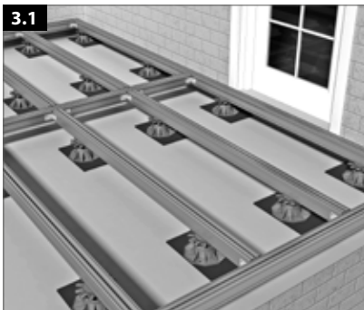
3.1 Ausbildung als Rahmen auf Bautenschutzmat- ten mit oder ohne Verwendung von Stellfüßen. Oder 4.3 (auch ohne Stellfuß, direkt auf Bauten- schutzmatten).
