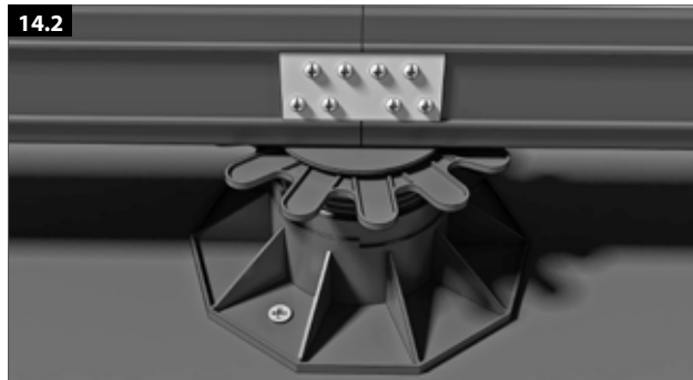
UK-Profile auf Stoß können durch ein Lochblech 40 x 80 mm verbunden oder mittig auf der Betonplatte auf Stoß gesetzt werden. Der Stoß muss auf einem Unterstützungspunkt angeordnet werden. Der Stoß nebeneinander liegender UK-Profile ist versetzt anzuordnen.
