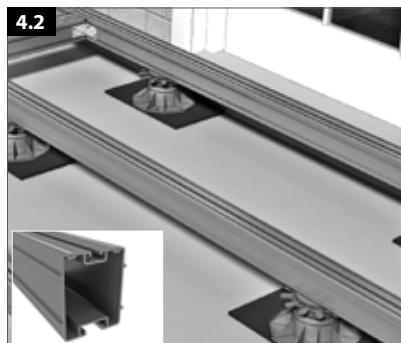
4.2 Verwendung des hohen UK-Profiles 80 x 70 mm mit Stellfüßen . Gewährleistung des Wasserablaufs. Stellfüße anschrauben (4.2.) oder mit Betonplatten (min. 40 x 40 x 4 cm) beschweren (4.3.).
