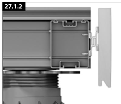
Verwendung einer Bodendiele Anschrauben im Abstand von 31 mm zur Oberkante
