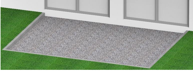
Bild 1. Eine Steinumrandung verhindert z. B. das Einwachsen des Rasens zwischen die WPC-Terrassendielen und stellt immer einen ausreichenden Fugenabstand und eine gute Belüftung unter der Terrasse sicher.
