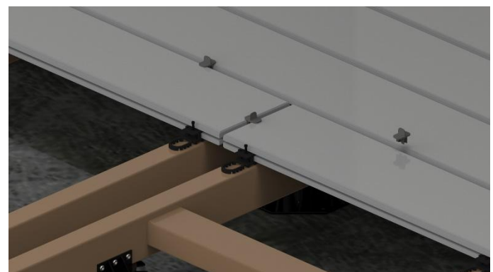
Bild 18. Damit immer ein Fugenabstand von 7 mm zwischen den Dielen und am Längenstoß eingehalten wird, nutzen Sie handelsübliche Abstandshalter.
