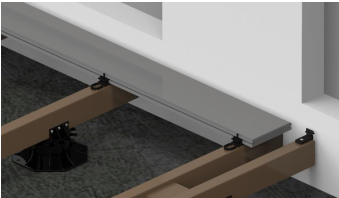
Bild 15. Die Dielenenden sollten an den Längenstößen ca. 30 mm bei Prime/Prime+/Terrain und max. 50 mm bei Reserve/Legacy überstehen.
