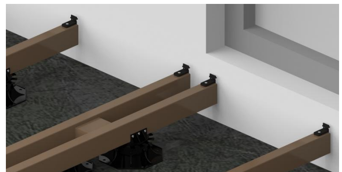
Bild 12. Montieren Sie die Starter-Clipse auf jeder Unterkonstruktion, das gilt auch für alle Längenstöße der Terrassendielen sowie am Stoß mit dem Drainageprofil. Beachten Sie auch die 14 mm Breitendifferenz zwischen der 136 mm Diele und dem 150 mm Drainageprofil.
