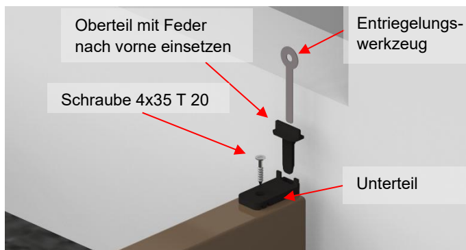
Bild 9. Der Starter-Clip besteht aus einem Unterteil und einem Oberteil und wird nicht zusammengebaut geliefert. Sie können zuerst nur die Unterteile auf die Unterkonstruktionen verschrauben.
