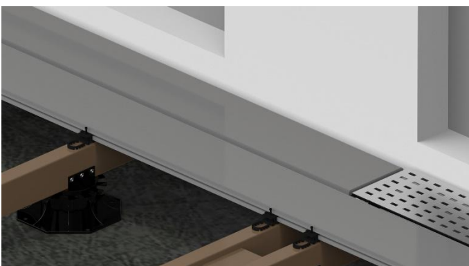
Bild 17. Wenn die erste WPC-Diele und das Drainageprofil so fixiert wurden, kann die zweite Dielenreihe auf die Clipse geschoben werden. Schieben Sie dann die nächsten Clipse unter die zweite Diele und drehen die Schrauben 4,2 x 50 mm (T 15) nur so weit ein, dass der Clip nicht mehr verrutschen kann.
