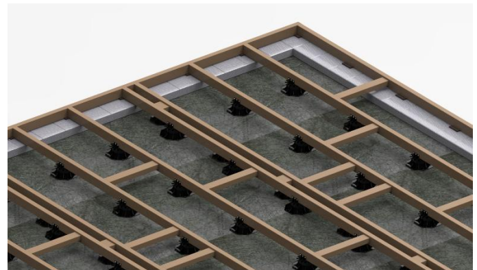
Bild 4. Wenn die Terrassenlager an den Unterkonstruktionen angeschraubt wurden, müssen zur Aussteifung in jedem Feld mind. 2 Querstücke eingebaut werden. Die Querstücke können direkt mit der Unterkonstruktion verschraubt werden.
