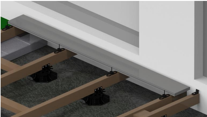
Bild 13. Stecken Sie die erste Terrassendiele auf die Starter-Clip und schieben auf der anderen genuteten Seite der Terrassendiele die Clipse unter die Diele. Hinweis: Clip hat eine Sollbruchstelle, die beim Festziehen der Schraube leicht knackt.
