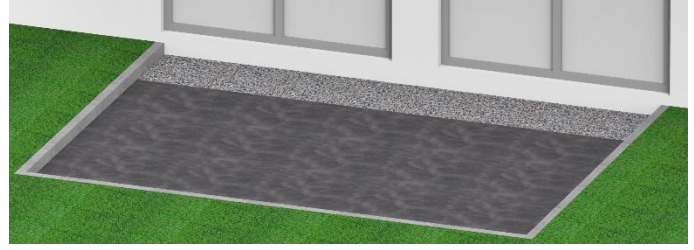
Bild 2. optional kann auf die Bettungsschicht ein wasserdurchlässiges Unkrautvlies verlegt werden. Die Bahnen sollten ca. 10 cm überlappen.
