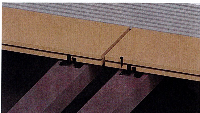
Bild 25. Die WPC-Dielen sollten max. 40 – 45 mm über die Unterkonstruktion überstehen und jede Diele muss mit einem Clip befestigt werden.
