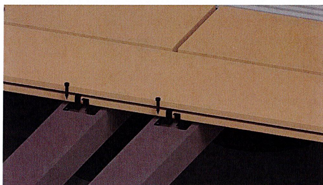
Bild 26. Auch die durchgehenden Dielen sollten mit 2 Clipsen befestigt werden.
