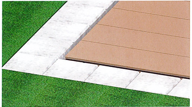
Bild 31. Der Fugenabstand an der letzten WPC-Diele beträgt bei richtiger Montage ca. 20 mm zur Steinkante und der Abstand der Unterkonstruktion beträgt ca. 10 mm.
