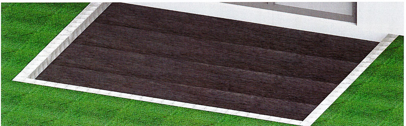
Bild 3. Eine Steinumrandung verhindert z.B. das Einwachsen des Rasens zwischen die WPC-Terrassendielen und stellt immer einen ausreichenden Fugenabstand und eine gute Belüftung unter der Terrasse sicher.
