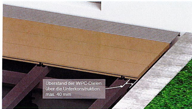
Bild 24. An den äußeren Unterkonstruktionen darf der Überstand der WPC-Dielen max. 40 mm betragen. Der Fugenabstand an den Dielenenden zu festen Bauteilen muss 20 mm betragen.
