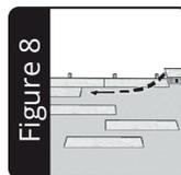
salmesser (mehrere Male) und knicken Sie das Paneel. Anschliessend ist die Beschichtung auf der Unterseite des Paneels durchzuschneiden.
