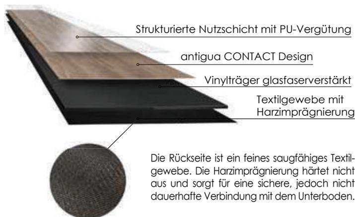
Die Rückseite ist ein feines saugfähiges Textilgewebe. Die Harzprägnierung härtet nicht aus und sorgt für eine sichere, jedoch nicht dauerhafte Verbindung mit dem Unterboden.
