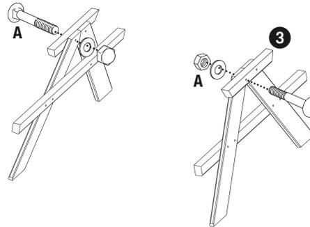
Trocknungsbedingt kann es sein, dass Bohrungen nicht genau überein passen. In diesem Fall bohren Sie die Löcher mit 6 mm nach.
