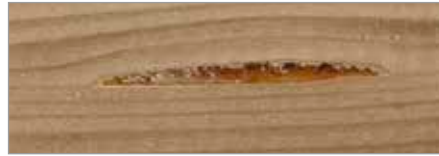
Harzgallen mit Entharzer entfernen
