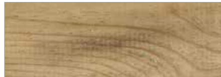
Stockflecken mit chlorhalt. Reiniger entfernen
