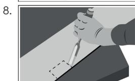
Ausklinkungen können mittels Säge und Stecheisen vorgenommen werden.
