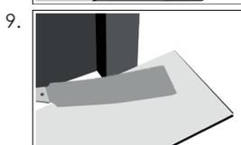
Feste Bauteile wie Tüorzargen müssen gekürzt werden, damit der **antigua-Fertigfußboden** darunter liegen kann. Es darf nicht anstoßen. Vor der Kürzung der Tüorzarge muß geprüft werden, dass die Tüorzarge dauerhaft befestigt ist. Ein Absacken der Tüorzarge könnte die Bewegungsfreiheit des **antigua-Fertigfußboden** beeinträchtigen. Aufgrund dessen sollte auch auf eine Silikonfuge verzichtet werden!
