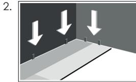
Eine Dehnfuge von mind. 10 mm zwischen dem **antigua-Fertigfußboden** und der Wand sowie allen festen Bauteilen wie Heizungsrohre, Tüorzargen usw. muss zwingend eingehalten werden. Raumlänge bis 10 m = 10mm Dehnfuge; bei einer Raumlänge ab 10 m je weiteren Meter 1 mm Dehnfuge zusätzlich einhalten (maximale Raumgröße 15 m Länge und 10 m Breite).
