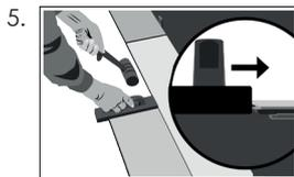
Zum Zusammenfügen der Kurzseite schlagen Sie diese mit der **KWG Schlagleiste (Art.-Nr.: 840030)** an der Nutseite vorsichtig ineinander. Schlagen Sie nie die Federseite, da diese sonst beschädigt werden kann. Bei zu starkem Zusammenklopfen kann sich die Vinylauflage im Kantenbereich hochdrücken. Für die letzte Diele in einer Reihe benötigen Sie ein Zugeisen zum Zusammenfügen.
