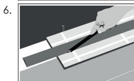
Die letzte Dielenreihe wird in die richtige Breite gesägt. Dabei ist auf die Dehnungsfuge zu achten! Danach wird die Dehnungsfuge mit einer Fußleiste abgedeckt. Sie darf allerdings nicht zu dicht auf dem **antigua-Fertigfußboden** liegen, um die Bewegungsfreiheit des Bodens nicht zu beeinträchtigen.
