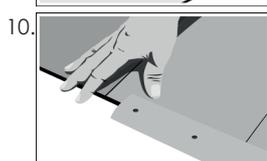
Übergänge zwischen dem **antigua-Fertigfußboden** und anderen Bodenbelägen sowie zwei aneinanderliegenden Räumen müssen generell mit einem Parkettprofilssystem abgedeckt werden.
