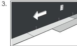
Bei den Dielen der ersten Reihe wird die Feder der Langkante mit einer geeigneten Säge abgeschnitten, so dass die Schnittkante zur Wand zeigt. Die folgenden Dielenreihen sollen mind. 1/3 versetzt verlegt werden. Optimal ist die Verlegung im Halbverband (mind 30 cm).
