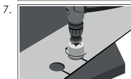
Für Rohranschlüsse werden Löcher gebohrt, deren Durchmesser ca. 20 mm größer sind, als der des Rohres. Nachdem die Diele verlegt ist, wird das Reststück eingesetzt. Die Abdeckung erfolgt nachträglich mit Rosetten.
