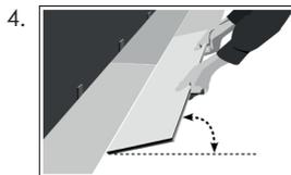
Der **antigua-Fertigfußboden** wird üblicherweise nicht geleimt, sondern trocken verlegt. Dabei werden die einzelnen Dielen mit der Feder der Langkante in die Nut der davor liegenden Diele in einem Winkel von 20-30° eingedreht, indem man die Diele auf und ab bewegt. Die Langkante kann zusätzlich mit der **KWG Schlagleiste (Art.-Nr.: 840030)** zusammen geklopft werden. Bitte achten Sie vor der Verlegung darauf, dass Nut und Feder frei von Spänen oder sonstigen Verunreinigungen sind.
