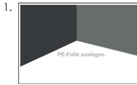
Es ist zu empfehlen an einer geraden Wand, längs zum Lichteinfall, von rechts nach links zu beginnen. Eine Dampfsperre ist bei allen mineralischen Untergründen unerlässlich. Legen Sie dazu eine mindestens 0,2 mm starke PE-Folie unter den **antigua-Fertigfußboden**, wobei die Stoßkanten ca. 20 cm überlappen und abgeklebt werden müssen. An den Wänden ist die Folie ca. 3 cm hochzuziehen. Wir empfehlen Ihnen die Übergänge mit einem Klebeband abzukleben.
