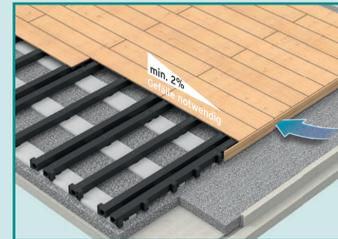
Geschlossene Fuge mit Fugenprofil P5
