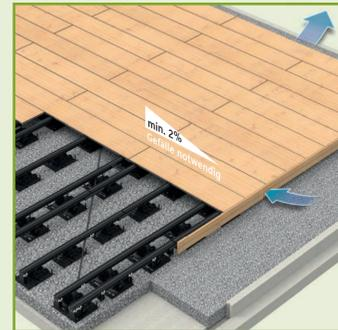
Geschlossene Fuge mit Fugenprofil P5\*
